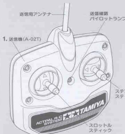
1. 送信機 (A-02T) = コントロールボックスとなるもので、ステアリング、スロットルの操作を電波信号に変えて発信します。
